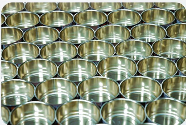
Il lamierino rivestito di stagno (detto banda stagnata) o cromo (detto banda cromata), è il semilavorato d'acciaio di partenza utilizzato per ottenere imballaggi di varie forme e dimensioni destinati agli usi più diversi.
