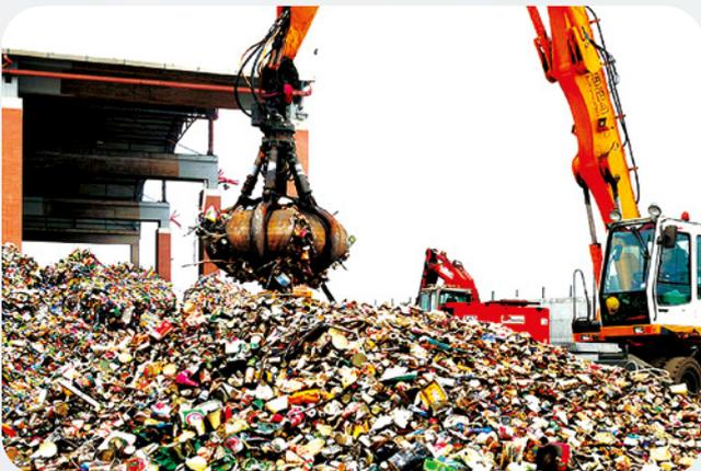
Si tratta di una serie di operazioni molto importanti, prima fra tutte la selezione, attraverso sistemi magnetici, per separare l'acciaio da frazioni di materiale diverso. Seguono poi operazioni di pulitura, frantumazione o riduzione volumetrica e l'eventuale distagnazione.
